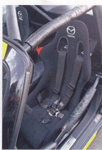
Exzellente konturierte Rennschalensitze mit Sechspunktgurt, mit Schaumstoff ummantelter Überrollkäfig
