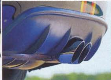
Angedeuteter Diffusor und mächtiger, mittig montierter Doppelrohr-Sportauspuff
